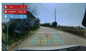
舗装損傷 AI 解析イメージ
